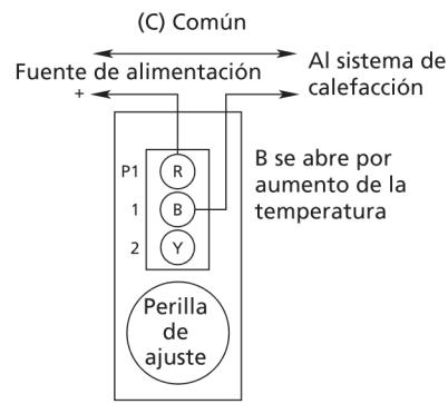
Figura 1 – Conexión para un Circuito Típico de Control de Calefacción
