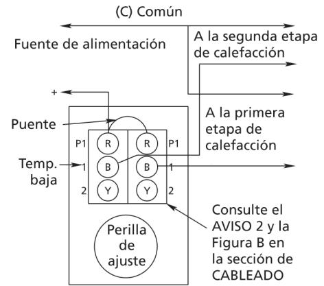
**Figura 7 – Termostatos SPDT/SPDT de Dos Etapas en Control de un Sistema de Calefacción de Dos Etapas**
